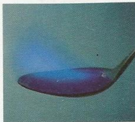
FIGURA C.1 O enxofre elementar queima com uma chama azul e produz o gás denso de dióxido de enxofre, um composto de enxofre e oxigênio.
